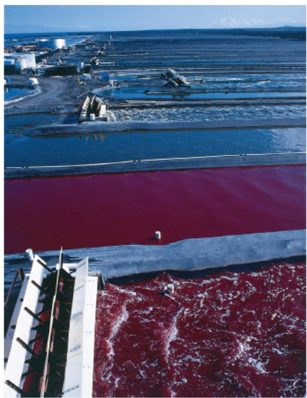
Photobioréacteur solaire pour la culture d'Haematococcus p. à Hawaï
